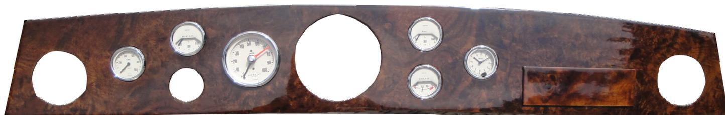
**Armaturenbrett gefertigt für 6x51er, 1x80er und 1x127mm Instrument (Mitteltacho)**
